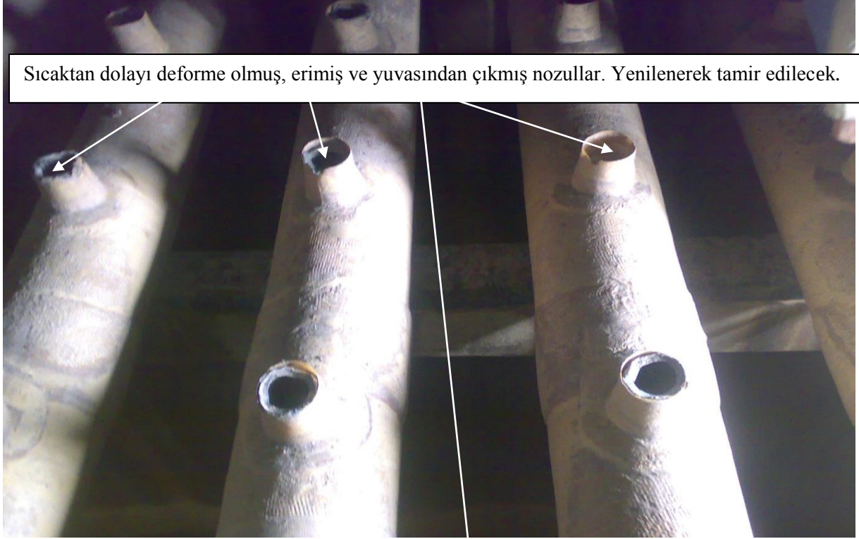
Şekil 1: Mevcut FGD sistemdeki erimiş nozulların bire bir fotoğrafı
