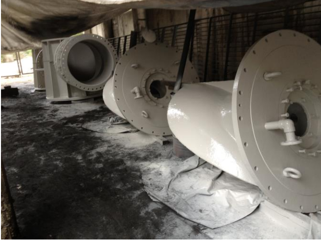
EURO COAT 1348 ile İlk kat kaplanmış ve son kat kaplanmış hali
