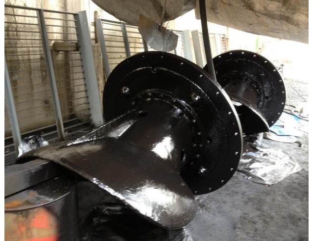
EURO COAT 1348 ile İlk kat kaplanmış ve son kat kaplanmış hali
