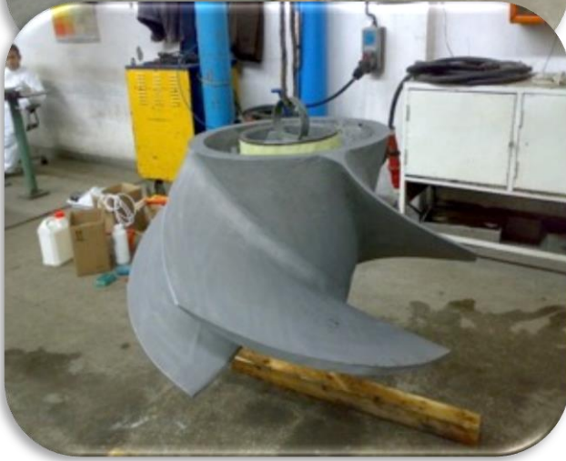
Erezyondan ve kavıtasıyondan aşınmış hali
