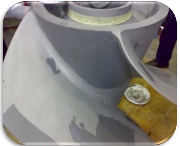
Aşınmış yerlerin dolguları yapıldı
