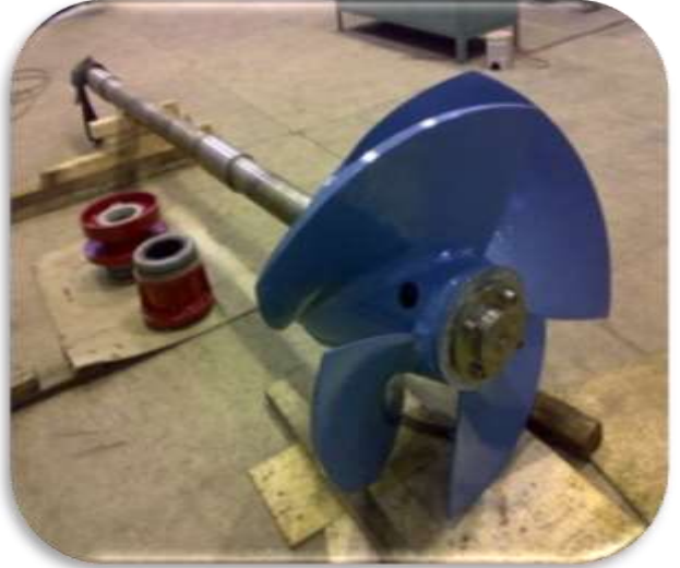
Sıvı Seramik Kaplanmış hali önde
