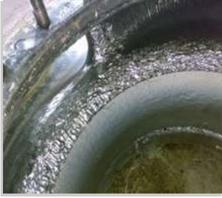
Erozyondan ve kavitasyondan aşınmış hali
