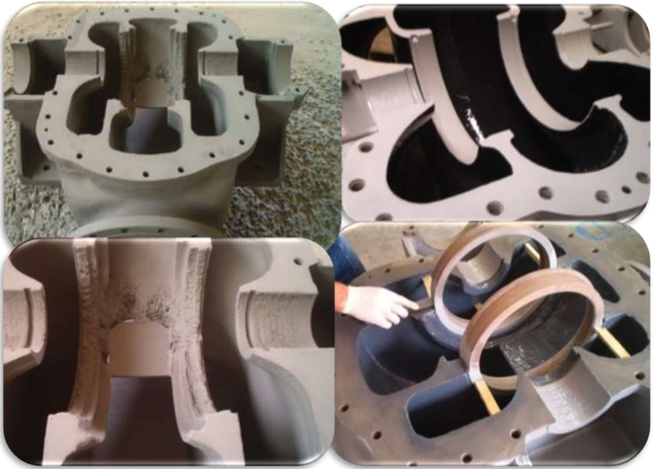
Pompa gövdelerindeki o-ring yerleri dolgu ile tamir edilirken
