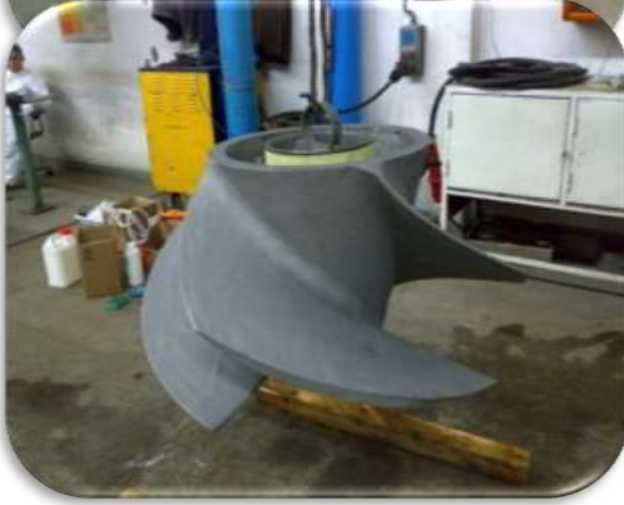
Erezyondan ve kavitasyondan aşınmış hali
