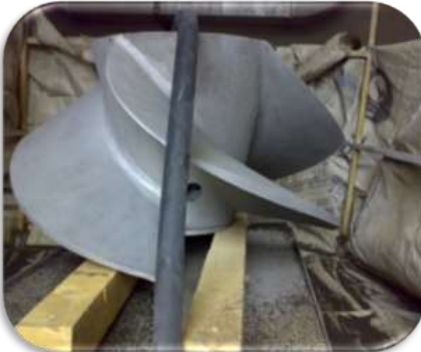
Kaplanmadan önce raspalanmış hali
