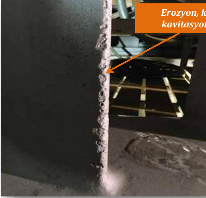
Entrainment ( Sürüklenme Erozyonu ) Çarktan suyun kep bölgesine çarparak sürüklendiği yerde.
