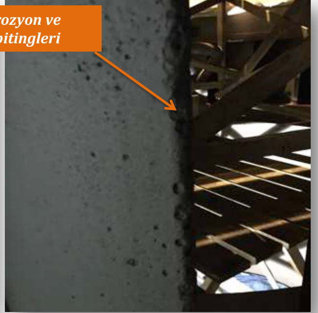
Impingement ( yüksek hızdan düşük hıza geçiş erozyonu ) Kep bölgesinde
